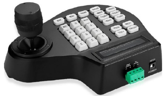
Фактическая конструкция PS-C1: RS-485 OUT/IN, питание DC 12 В
