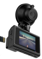
Затем вставьте карту памяти наполовину. Затем ногтем пальца или скрепкой полностью вставьте карту внутрь, пока она не защелкнется и не зафиксируется на месте.
