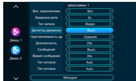
Этот интерфейс может устанавливать параметры вызывной панели 1 и вызывной панели 2 соответственно.
